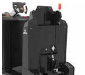
Acoplamento automático com alça de destravamento ergonômica
