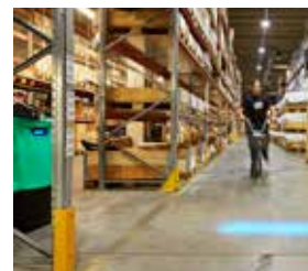
Luz de segurança de ponto azul na direção de condução (garfos atrás).
